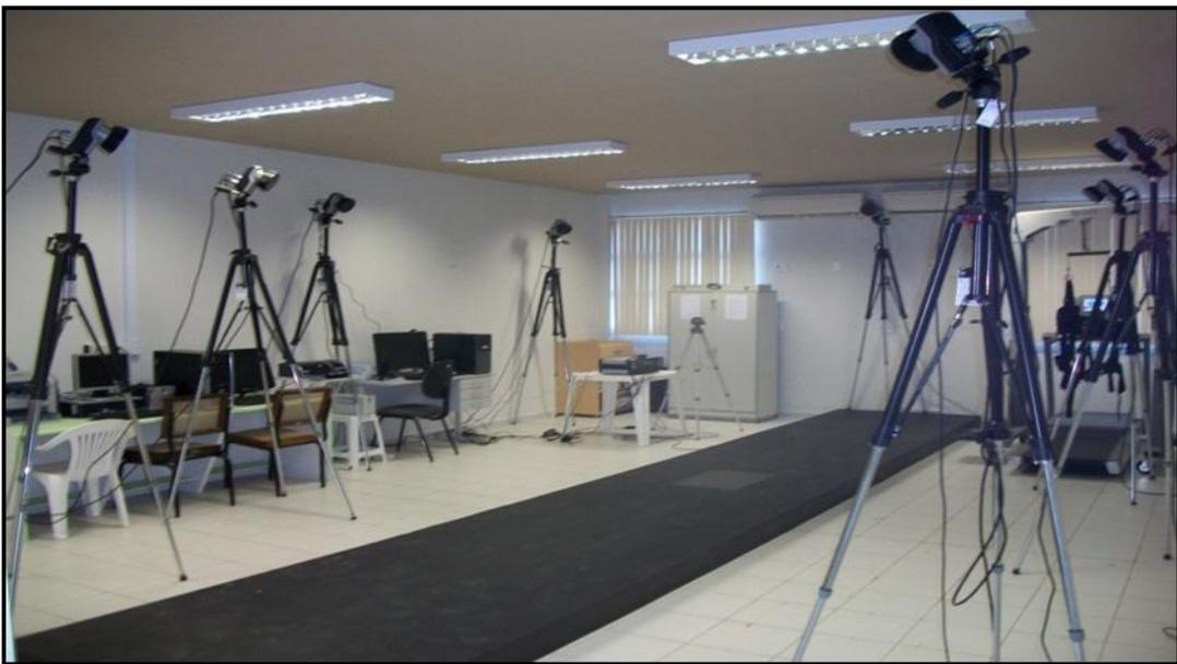
**Figura 2** - Disposição das câmeras em torno da passarela de coleta
